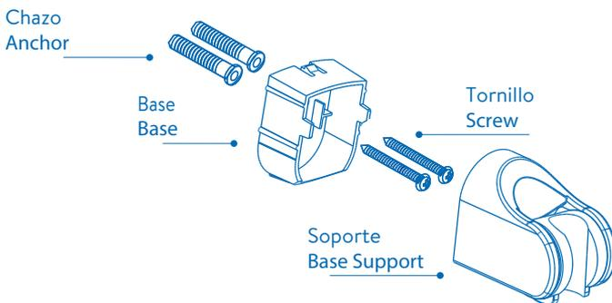
“Este sistema de instalación está especificado para muros en mampostería, No se recomienda instalar en otro tipo de muros (muros livianos)”
